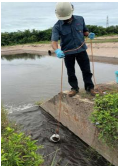
รูปที่ ค-6 การเก็บตัวอย่างตรวจวัดคุณภาพน้ำทิ้ง ของท่าเทียบเรือขนถ่ายน้ำมันเชื้อเพลิงสำหรับโรงไฟฟ้ากระบี่
