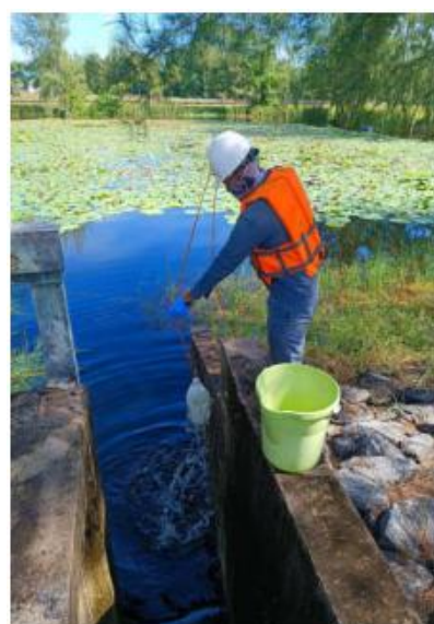
รูปที่ ค-6 การเก็บตัวอย่างตรวจวัดคุณภาพน้ำทิ้ง ของท่าเทียบเรือขนถ่ายน้ำมันเชื้อเพลิงสำหรับโรงไฟฟ้ากระบี่
